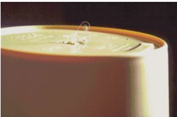
Figuur 1-41: Het aanspuitpunt moet worden verwijderd.
